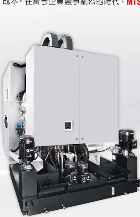
整體化的水箱設計可搭配鐵屑輸送機與中心出水設備。
